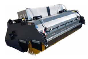
É construída em cinco modelos com larguras de trabalho de 2000 mm a 3000 mm e é aplicada em máquinas operacionais de alta potência.
