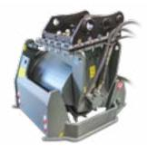
Zum Abtragen des oberen Straßenbelags, des Zements auf Plätzen, zum Abkratzen von Fels bzw. zum Erstellen von Querungen oder Spuren, wo gepflastert wird. Es wurde eigens zum Einsatz auf Baggern entwickelt, hergestellt in 5 Modellen mit einer Breite von 20 bis 60 cm. Gearbeitet werden kann in erheblicher Höhe, an senkrechten Wänden und an Pfeilern von Überführungen.
