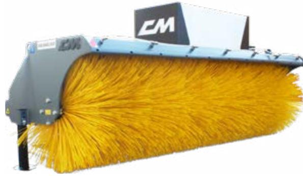
Sin cuchara de recogida, solo con cepillos de polipropileno. Funciona con el circuito hidráulico de la máquina operadora y se produce en 9 modelos con anchos de trabajo de 105 a 300 cm.
