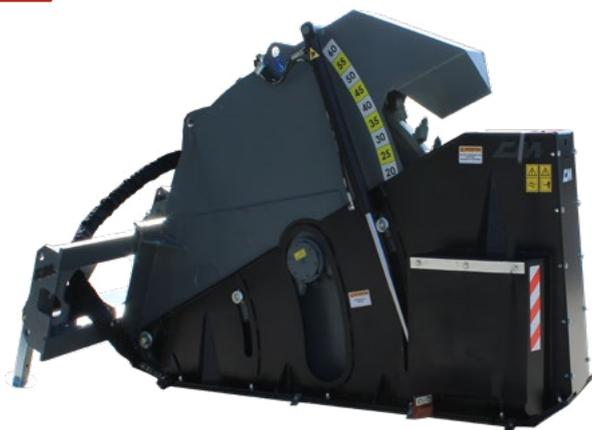
Rueda zanjadora diseñada para aplicaciones en cargadoras compactas, Multiskid CM radiocontrolada, con el objetivo de realizar pequeñas excavaciones, minizanjas y microzanjas para el tendido de cables de fibra óptica. Trabaja en diversas superficies como asfalto, roca y hormigón.
