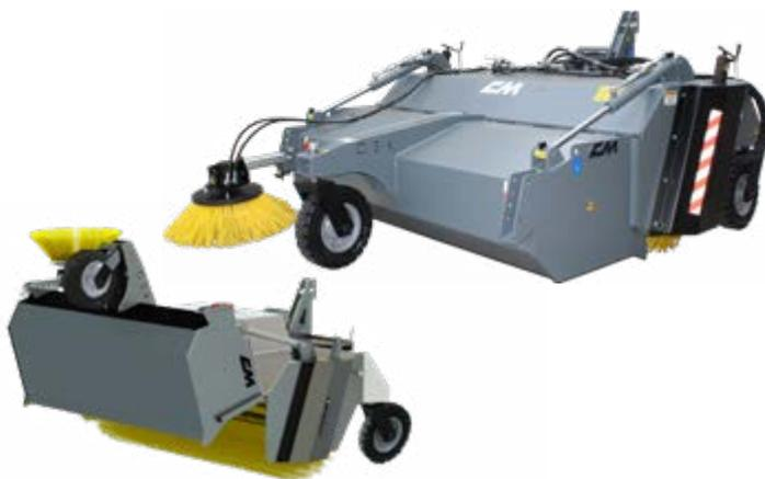
Spazzatrice, dotata di benna di raccolta, spazzole in polipropilene e ruote d'appoggio girevoli, particolarmente indicata per il settore dei lavori comunali e per i lavori da cantiere. Completa di attacco flottante per adattarsi alla conformità del terreno, è equipaggiata con pistoni idraulici che, oltre a consentire lo scarico idraulico della benna, permettono di sollevare la benna stessa per lavorare in modalità di spazzamento, senza raccogliere il materiale.
