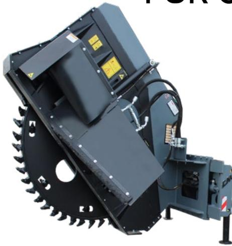
Radfräse für den Anbau an Kompaktlader, Multiskid CM funkgesteuert, zur Herstellung von kleinen Ausgrabungen, Minigräben und Mikrogräben für die Verlegung von Glasfaserkabeln, arbeitet auf verschiedenen Untergründen wie Asphalt, Fels und Beton.
